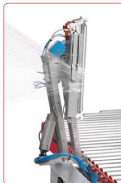
*Sistema di pinza taglio saldatura del film estensibile, autoregolante per vari dimensioni del pallet.*
